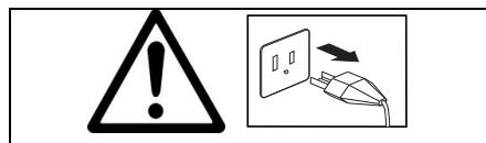
Prima di sostituire il fusibile, scollegare lo strumento dall'alimentazione elettrica.
