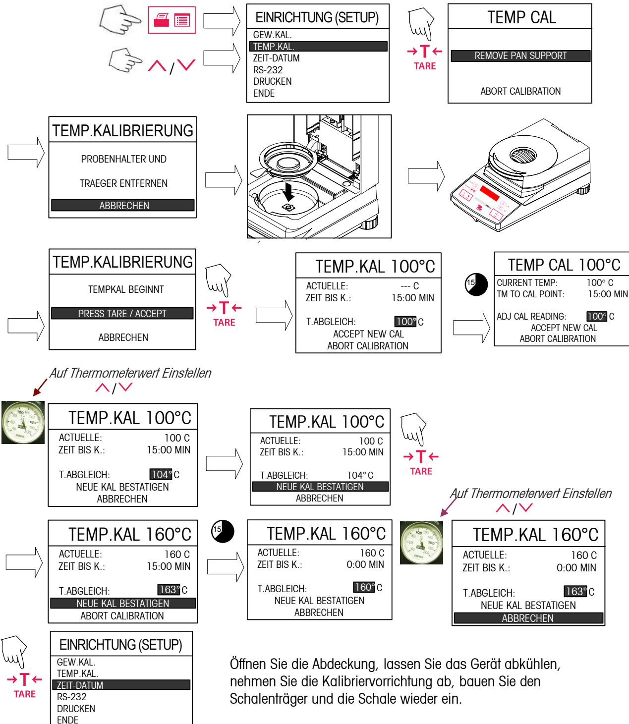
Öffnen Sie die Abdeckung, lassen Sie das Gerät abkühlen, nehmen Sie die Kalibriervorrichtung ab, bauen Sie den Schalenträger und die Schale wieder ein.
