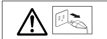
Vor dem Ersetzen der Sicherung muss das Gerät vom Stromnetz getrennt werden.
