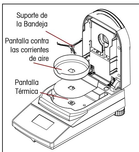
Instale la protector térmico, el corta aires y el soporte del platillo según se muestra. Gire el soporte del platillo hasta que se enganche en la posición bloqueada.
