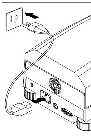
Das Netzkabel wie abgebildet anschließen. Der MB35 ist betriebsbereit, sobald die Stromzufuhr hergestellt ist. Die Anzeige bleibt ausgeschaltet, bis die **Ein-/Aus-Taste** gedrückt wird.
