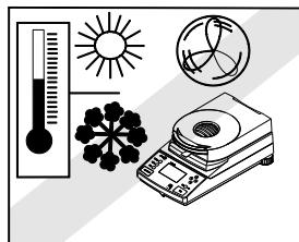
**NON** installare l'analizzatore di umidità nei pressi di:
