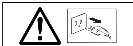
Vor einer Reinigung muss das Gerät vom Stromnetz getrennt werden.
