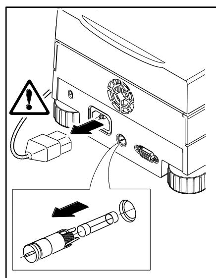
Utilice un destornillador para hacer girar el portafusible hacia la izquierda (sentido contrario al de las **saetas** del reloj) y saque el fusible.
