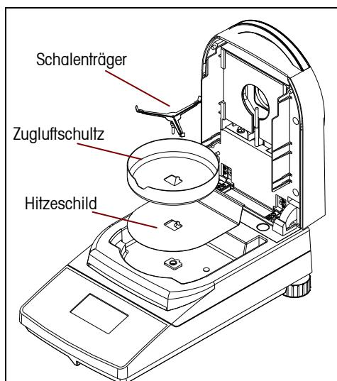
Installieren Sie das Hitzeschild, den Zugluftschutz und Schalenträger wie abgebildet. Drehen Sie den Schalenträger, bis er in der verriegelten Position einrastet.
