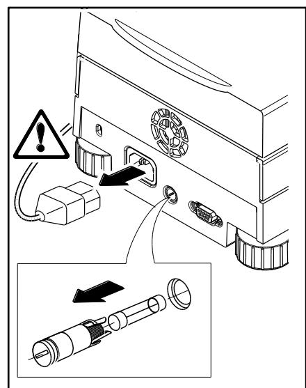
Con un cacciavite, ruotarne il supporto verso sinistra (in senso antiorario) e rimuoverlo.
