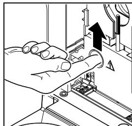
Alzare il coperchio superiore e rimuovere il coperchio del foro di accesso usando un giravite a testa piatta.
