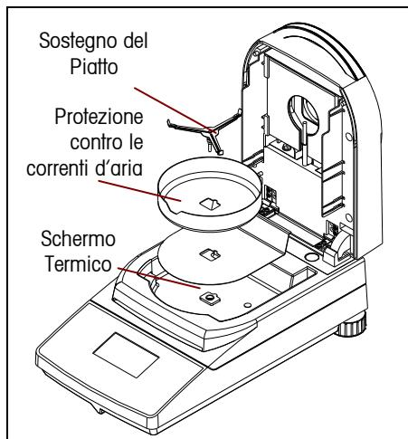
Installare lo schermo termico, la protezione contro le correnti e il sostegno del piatto come illustrato. Far ruotare il sostegno finché non scatta in posizione di blocco.
